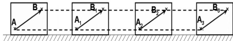
Un solide est en **mouvement de translation** si tout segment reliant deux points quelconques de ce solide **conserve la même direction**, c'est-à-dire lorsqu'il reste parallèle à lui-même au cours du mouvement.
