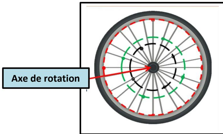
Un solide est en **mouvement de rotation** autour d'un axe fixe si tous les points du solide (n'appartenant pas à l'axe de rotation) sont en mouvement selon des trajectoires circulaires de même axe de rotation.
