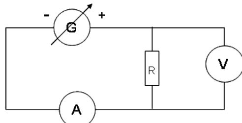
On relève alors la tension  $U$  en volt et l'intensité  $I$  en ampère donnés par les appareils de mesures. On consigne ces mesures dans un tableau
