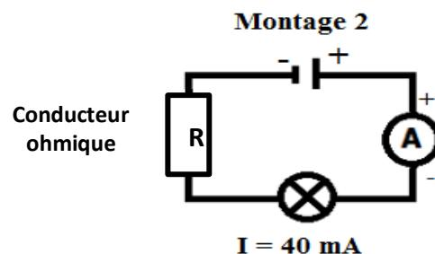
Lorsqu'on ajoute un conducteur ohmique (résistance) à un circuit électrique, la lampe ne brille bien et l'intensité de courant diminue.
