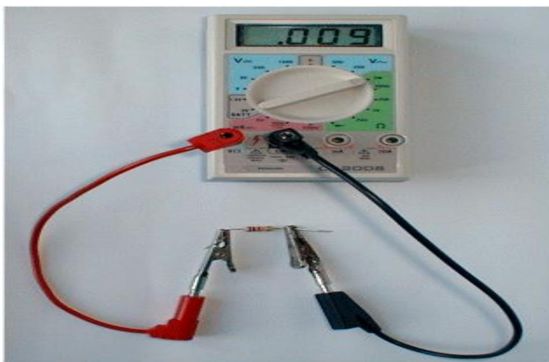
La résistance à mesurer est simplement branchée entre la borne COM et la borne repérée par la lettre Ω.
