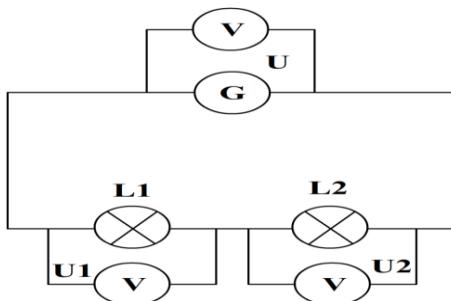
Dans le circuit ci-dessus, en appliquant la **loi d'additivité des tensions** on peut écrire:
