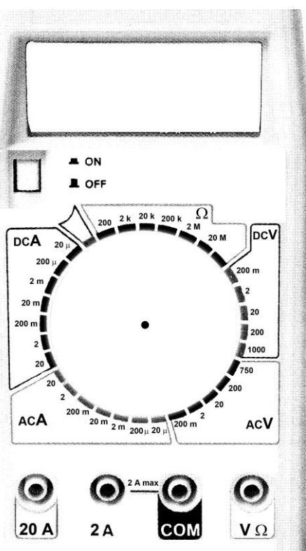
b. Indiquer sur le schéma les bornes que l'on doit utiliser pour les fils de connexion.
