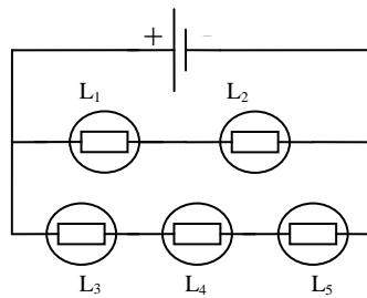
b- L'intensité  $I_1$  traversant  $L_1$  vaut **0,13 A**. Que vaut l'intensité traversant la lampe  $L_2$  ?
