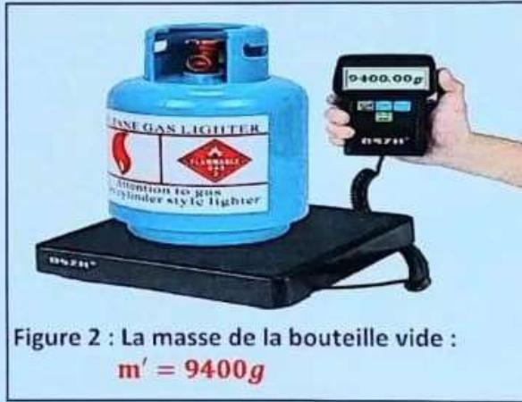
Figure 2 : La masse de la bouteille vide :  $m' = 9400\text{g}$
