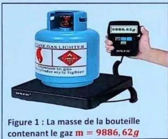
Figure 1 : La masse de la bouteille contenant le gaz  $m = 9886,62\text{g}$
